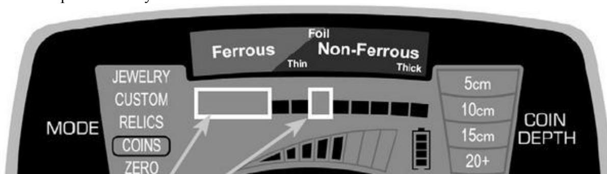
В режиме **COINS** четыре пикселя под железом и один пиксель фольги отключены.
