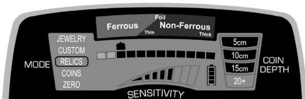
На рисунке сверху *EuroACE* работает в режиме RELICS, с двумя отключёнными пикселями дискриминации железа. Гвоздь, показанный на Рис. 1 на стр. 22, регистрируется над третьим пикселем. Эти железистые объекты могут быть исключены из нахождения при использовании кнопки ✓/✗, выключив третий слева пиксель.
