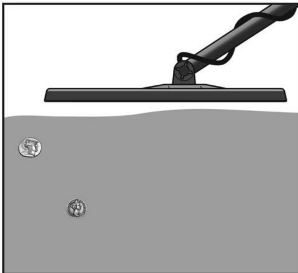
Вы можете изменить эту технику точной локализации цели, чтобы цель оказывалась под задней стороной DD-катушки; в этом случае катушку надо двигать от себя. Звуковые сигналы и сигналы на ЖК-мониторе покажут положение цели сразу за задней частью поисковой катушки.
