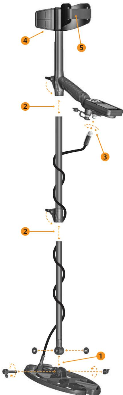
(1) Вставьте шайбы в нижнюю штангу, а затем присоедините нижнюю штангу в соответствующем месте к поисковой катушке. Закрепите поисковую катушку с помощью гайки и болта. Не затягивайте болт слишком сильно.
