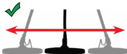
Для получения точных результатов важно всегда держать катушку параллельно земле при проходах.
